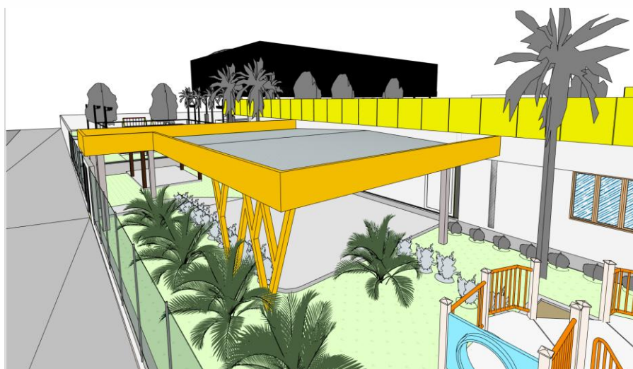
Figura 15 – Passarela de acesso principal – em estrutura metálica com telha metálica e fechamento com PAINEL FRIGO amarelo (seguir a mesma cor da platibanda existente).
