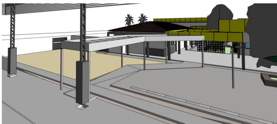
Figura 16 – Passarela de acesso entre a unidade escolar e a quadra de esportes – em estrutura metálica com telha metálica pintada de preto RAL9005.
