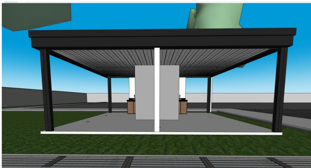
Figura 17 – Quiosque coberto com churrasqueira – em estrutura metálica com telha termoacústica com acabamento na parte inferior e superior, pintados na cor preto fosco.
